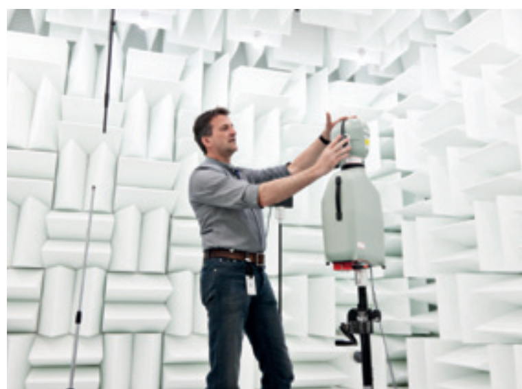
Simulateur tête et torse - "Mr. HATS" dans la chambre anéchoïque
